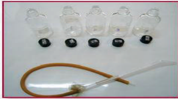
Gambar 1. Botol Wheaton untuk uji resistensi metode CDC bottle
