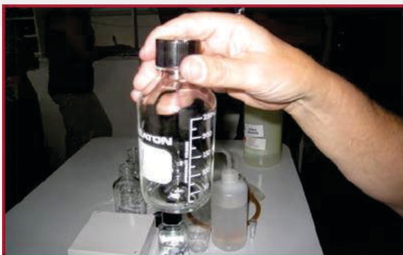
Pemolesan insektisida ( coating ) pada dasar botol
