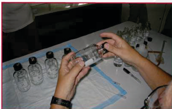
Pemolesan insektisida ( coating ) pada bagian samping dalam botol
